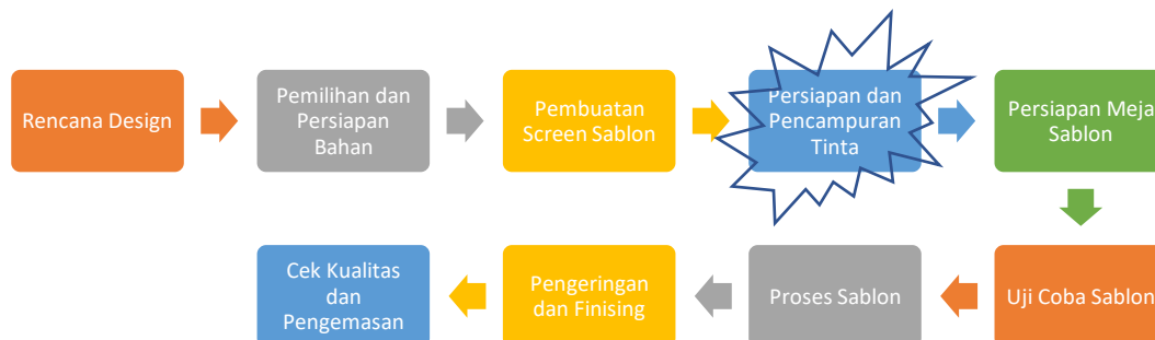
Gambar 3. Proses Pencetakan atau Sablon
